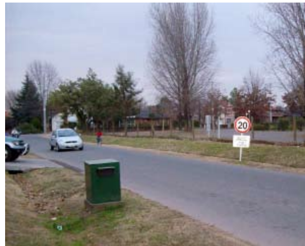
Imagen de un barrio cerrado. Dentro del cubículo verde funciona un radar que registra la velocidad de los vehículos, toma una fotografía y luego se aplica una multa si se excede el límite máximo permitido de 20 km/h., que es indicado por la cartelería respectiva. Los radares son rotados por distintas zonas, de modo de poder cubrir toda la superficie deseada a menor costo. Foto: Nicolás Lodeiro Ocampo.
